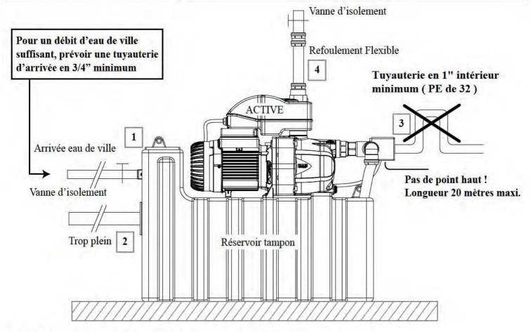
Le Pilotus sera installé à l'intérieur du bâtiment dans un endroit sec et correctement ventilé. Il peut – être posé au sol et fixé sur un mur, ou fixé directement au mur hors sol, attention l'ensemble en service pèse 41 Kg.
